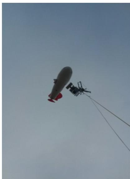
*Illustration 10: Ballon captif avec sa charge utile combinant mesure de la turbulence et contenu en eau liquide.*
