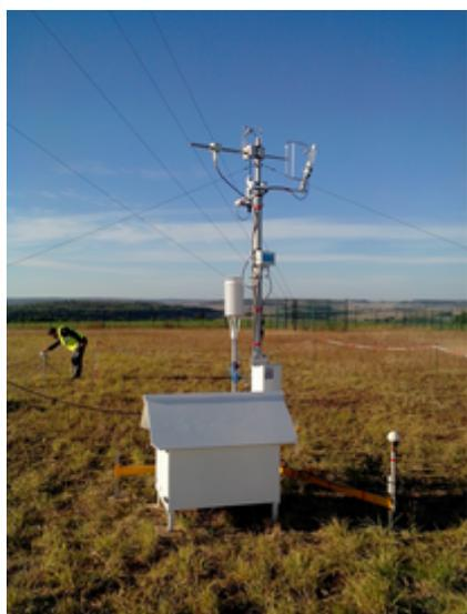
*Illustration 9: Station de mesure de flux à la surface.*
