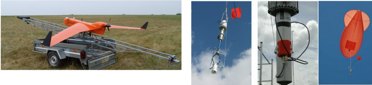
Figure 9 : Illustration de moyens d'observation innovants développés par le GMEI. A gauche : drone ayant des capacités d'emport de quelques kilogrammes et des durées allant jusqu'à 10 h permettant des mesures assez complexes comme les échanges turbulents d'énergie ou d'aérosols avec la surface océanique. A droite : sonde de turbulence avec anémomètre sonique et système électronique ; la centrale inertielle ; la sonde de turbulence sous le ballon captif.
