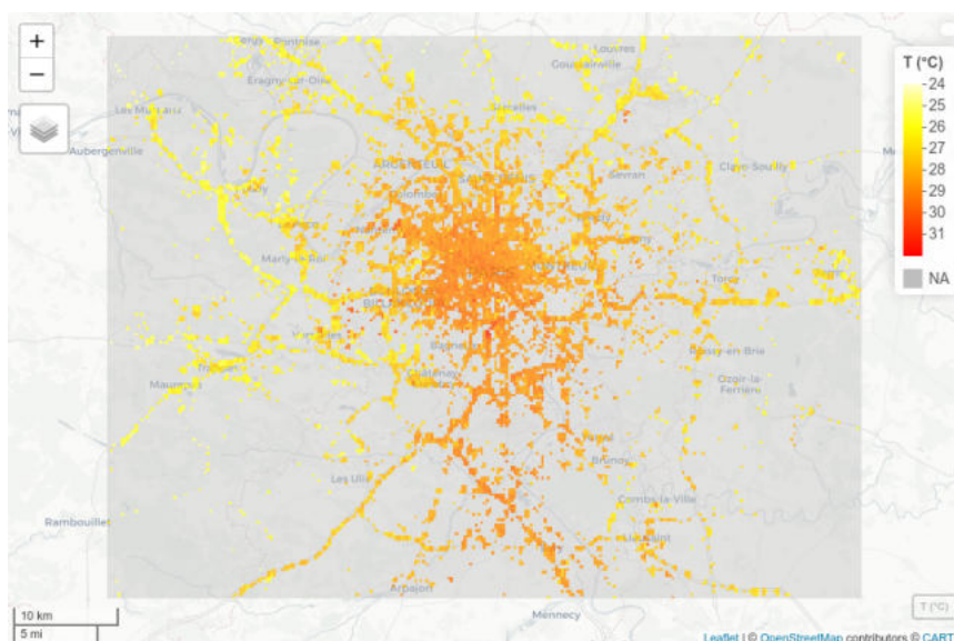
Figure 7 Îlot de chaleur observé par véhicules personnels connectés sur l'agglomération parisienne le 03 août 2018 à 21 UTC. Source : thèse (en cours) de E. Marquès (CNRM).
