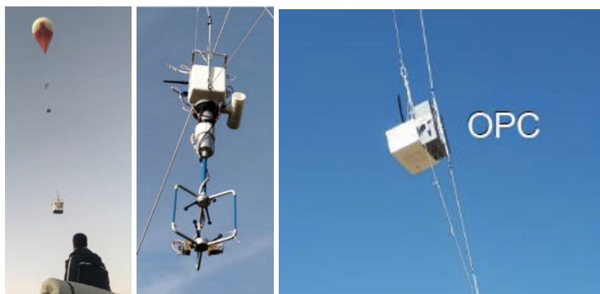
Figure 8 Ballons captif qui sera déployé par le CNRM sur un site en zone urbaine dense (à déterminer). Des mesures radiatives et granulométriques des aérosols seront réalisées. De gauche à droite : ballon, instrumentation de mesures de flux turbulents, compteur de particules.
