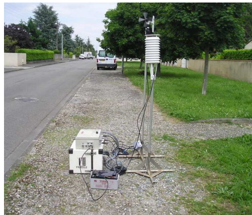
Figure 22 – a : Vélo instrumenté, équipé d'un capteur mesurant la température et l'humidité de l'air, et d'un GPS (gauche). b : Station météorologique fixe mesurant la température, l'humidité et le vent (droite).
