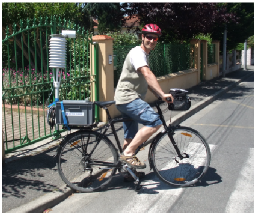
Figure 22 – a : Vélo instrumenté, équipé d'un capteur mesurant la température et l'humidité de l'air, et d'un GPS (gauche). b : Station météorologique fixe mesurant la température, l'humidité et le vent (droite).
