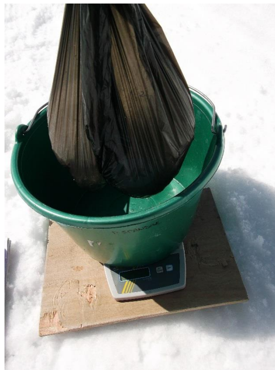
Figure 5- Pesée de la carotte de neige mise en sac (Source : P. Spandre et M. Lejeune 2016)
