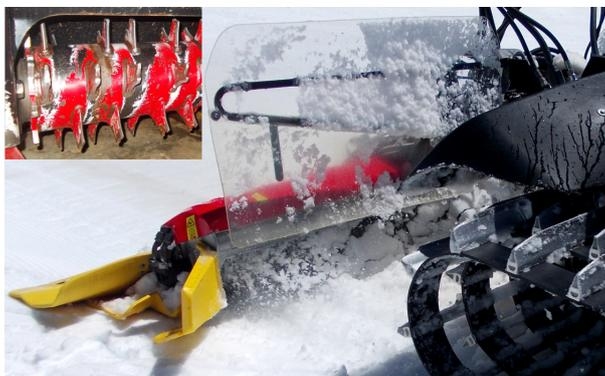
FIGURE 7 – La fraise est un outil monté à l'arrière de l'engin de damage constitué d'un arbre principal animé d'un mouvement de rotation surmonté de rangées de dents qui agissent comme un mixeur pour les couches de surface du manteau neigeux.
