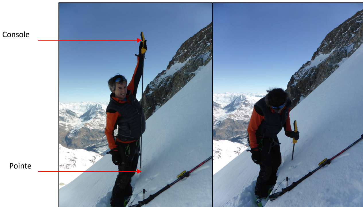
Figure 1.6 : mesure in-situ avec le SP1, La Grave le 19/03/2015 (source : T.Pilloix)
