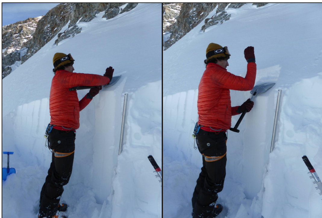
Figure 1.10 : Test de stabilité par Compression Test. A gauche, oscillation du poignet. A droite, oscillation du coude. (Source : T.Pilloix)
