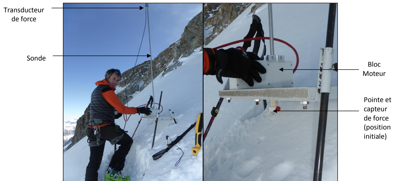
Figure 1.4 : Mesure in-situ avec le SMP, La Grave le 19/03/2015 (Source : T.Pilloix)
