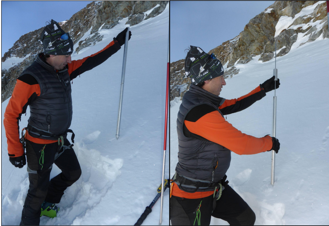
Figure 1.2 : Mesure de sondage par battage, La Grave le 19/03/2015 A gauche, lâché de la sonde à vide. A droite, le battage (Source : T.Pilloix)
