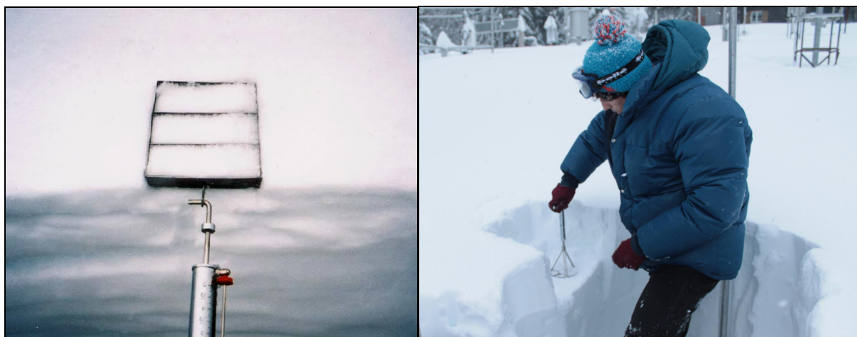
Figure 1.8 : A gauche, le cadre de cisaillement relié à un dynamomètre (Source : Evans Ed.J., 2005). A droite, mesure in-situ avec le scissomètre (Source : T.Pilloix)
