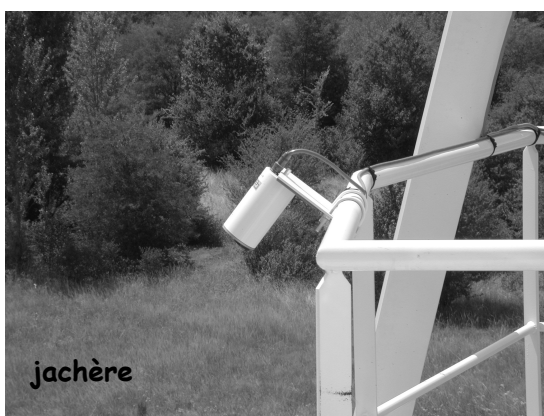
FIG. 3.8: Instrumentation dans les spectres visible, proche-infrarouge, moyen infrarouge et infrarouge thermique sur SMOSREX. A gauche : reflectancemètre CIMEL pour mesurer la réflectance de la jachère. A droite : pyromètres Heitronics pour mesurer la température infrarouge sur jachère et sur sol nu.
