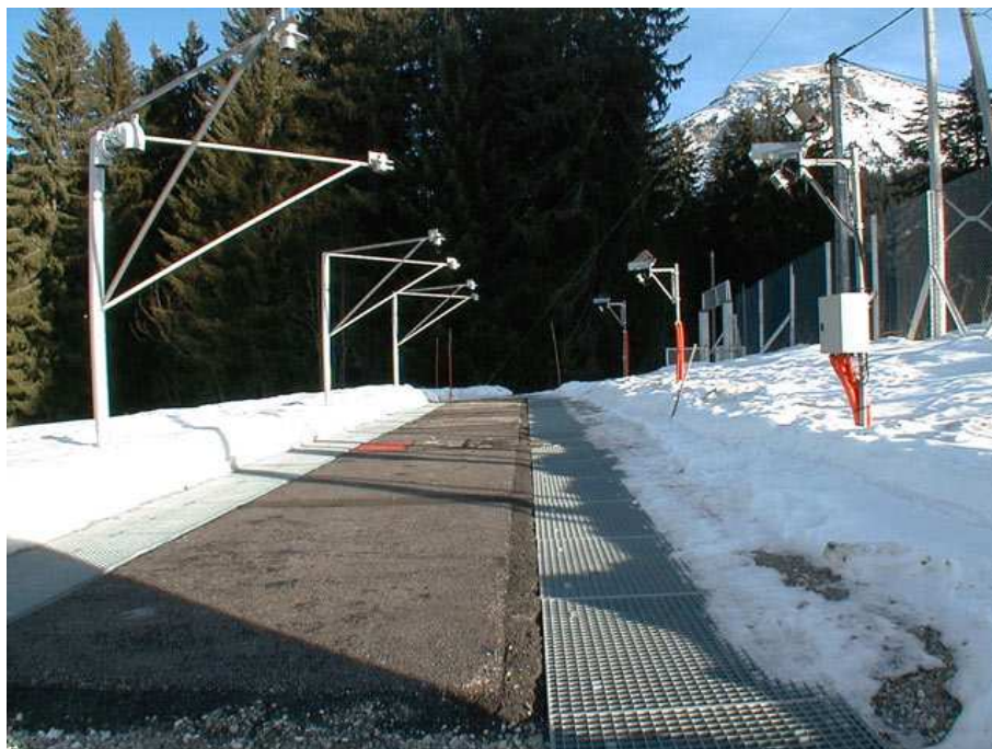
Figure 9 : Planches expérimentales de chaussées sur le site du Col de Porte, avec mesures de hauteur de neige, et caméras vidéo.
