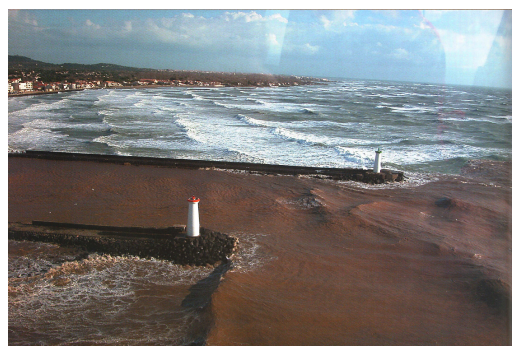
FIG. 3.14 : (a) Photographie du ressaut hydraulique à l'entrée de l'Hérault le 4 décembre 2003 à 12h d'après Hontarrède et al. (2004). (b) Évolution entre le 1 er et le 6 décembre 2003 de la houle à Banyuls et du niveau marin à Port-Vendres dans le département des Pyrénées-Orientales (Source : Météo-France).
