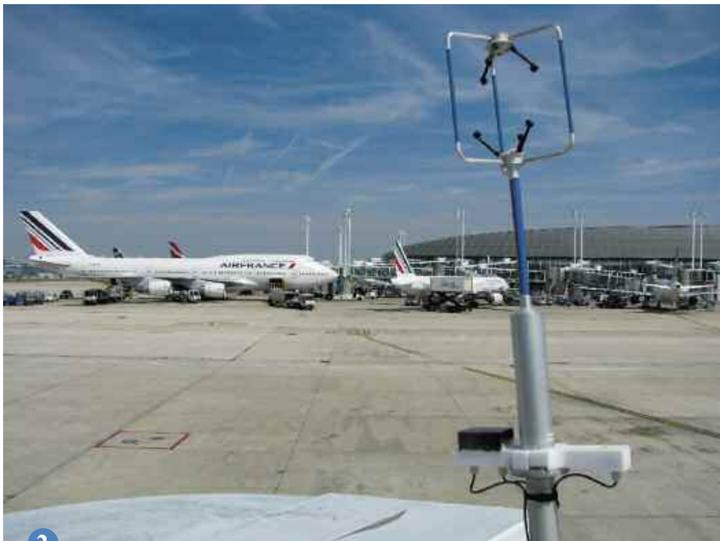
▲ Anémomètre installé sur une passerelle mobile au terminal 2F.
