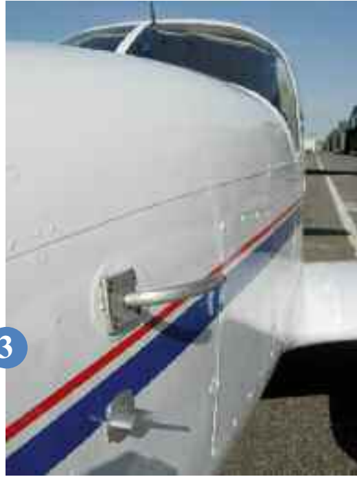
◀ Les veines de prélèvement d'air du Piper-Aztec.
