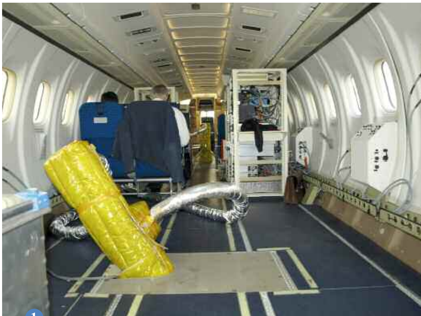
▲ L'une des 2 antennes CAROLS montée dans la fosse arrière de l'ATR 42.
