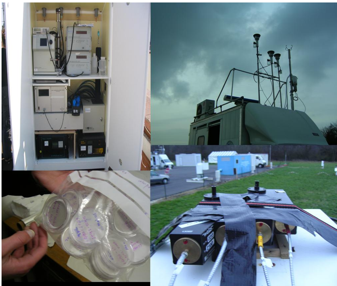
FIGURE 3.3 – Instruments microphysiques lors de la campagne de mesures ParisFOG. A haut à gauche, l'armoire contenant le SMPS et l'OPC (Pallas welas 2000). A haut à droite, les têtes de prélèvement sur filtres. En bas à gauche, des exemples de filtres pour le carbone organique et le black carbon. En bas à droite, les têtes de prélèvement des granulomètres OPC (Pallas welas 2000).
