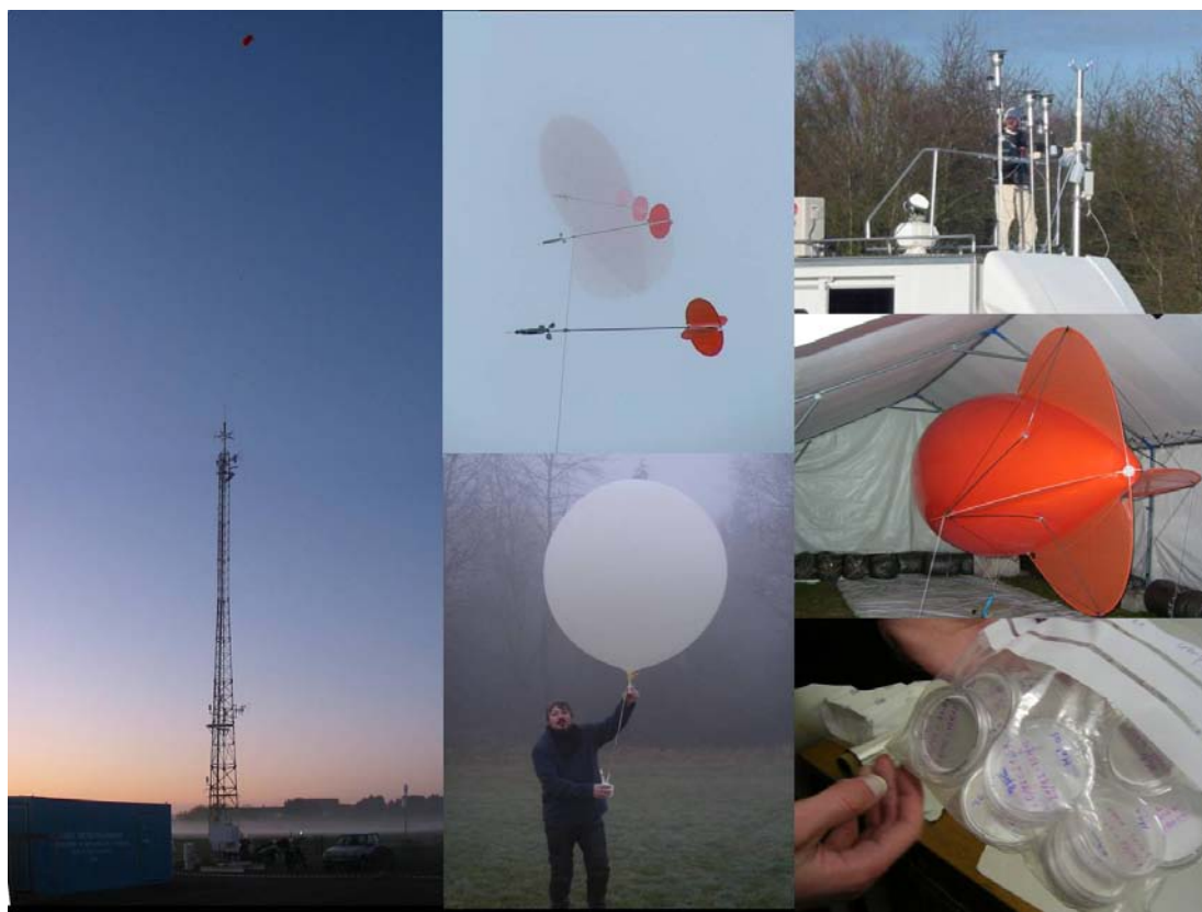
FIGURE 3.4 – Instruments déployés lors des périodes d'observations intensives de la campagne de mesures ParisFOG. A gauche, le ballon captif au-dessus du mât de 30m (Z1). Au milieu : une vue du ballon captif dans le brouillard et un lâcher de radiosondage au petit matin après une nuit d'observation intensive. A droite : installation de filtres sur les têtes de prélèvement, le ballon captif avant son déploiement et des exemples de filtres de prélèvement.
