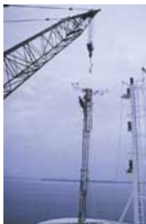
Un mât instrumenté de 10 m de hauteur fixé sur le pont avant du navire a permis une quantité importante de mesures sur la turbulence atmosphérique.
