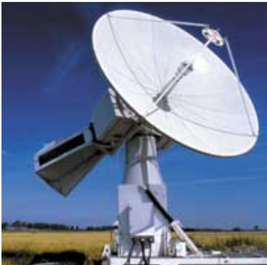
Le radar Ronsard utilisé durant la campagne MAP a permis de suivre en temps réel les champs tridimensionnels de vent au-dessus des reliefs.
