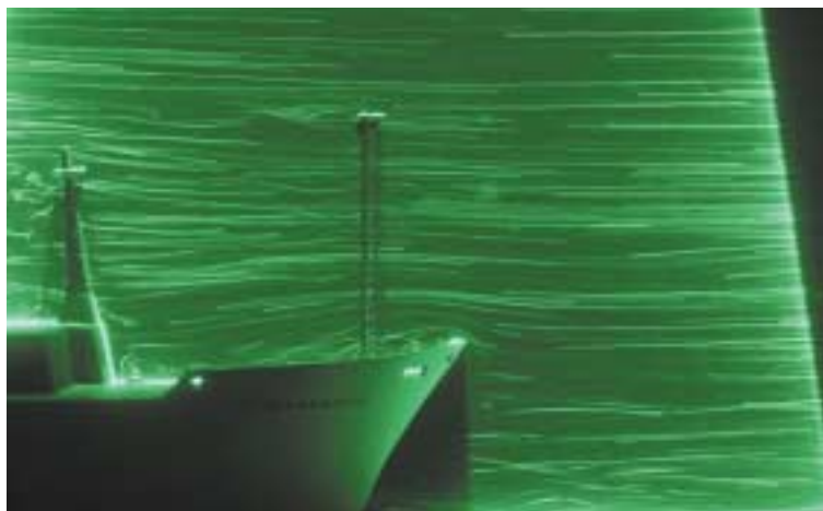
Visualisation du vent autour du pylône sur la maquette du navire océanographique Atalante
