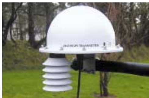
La station automatique Minos développée par Météo-France
