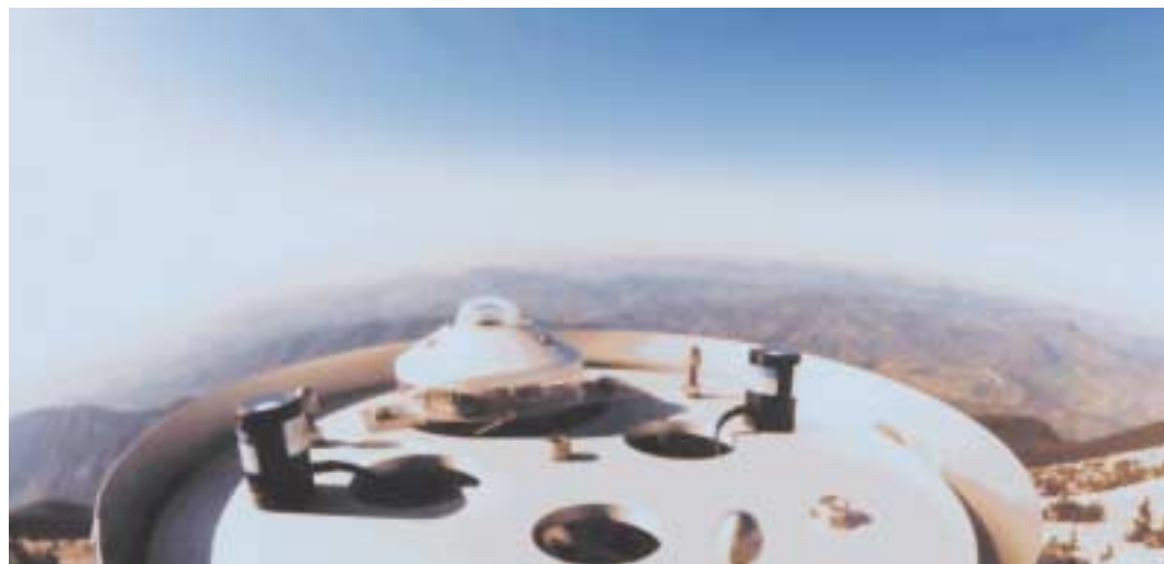
Télémètre de nuage à laser permettant l'observation continue de la couche des aérosols
