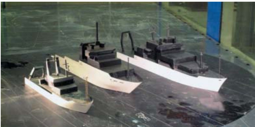
Maquettes des navires océanographiques Suroît, Thalassa et Atalante dans la veine hydraulique de Météo-France.
