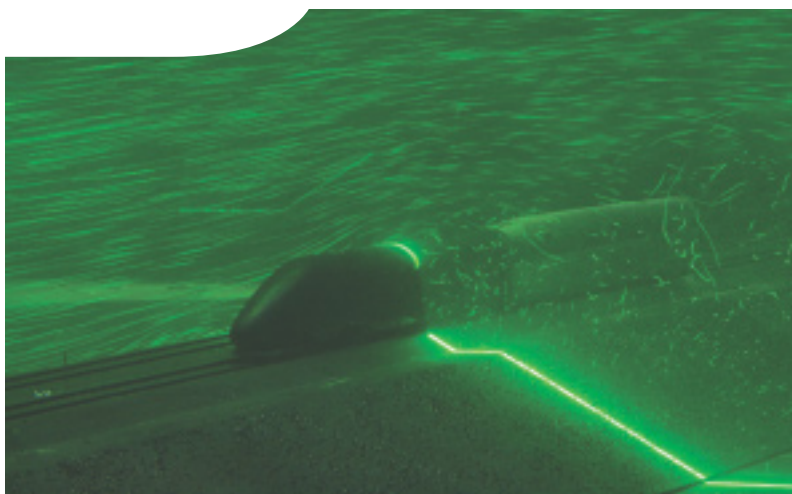
Écoulement turbulent autour d'une rame de TGV lors de son passage sur un remblai surélevé.
