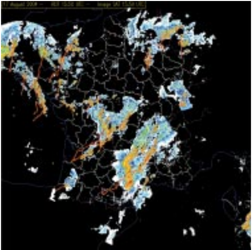
Suivi automatique des orages. Sur l'image radar composite du 17 août 2004 à 15h50, les contours oranges délimitent les objets Opic-radar qui sont caractérisés et suivis automatiquement. Les lignes rouges montrent la trajectoire passée de ces orages et témoignent tant de la qualité du suivi que du potentiel de faisabilité d'avertissements à très courte échéance basés sur de tels diagnostics.
