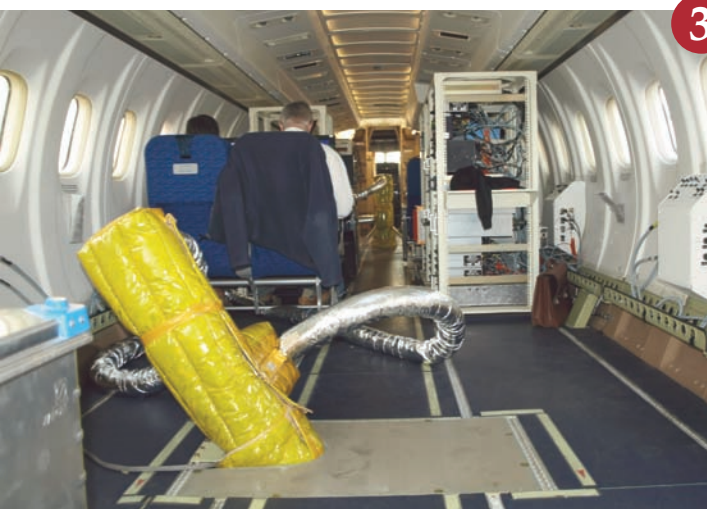
▲ Installation en cabine du radiomètre Carols (l'antenne est recouverte d'une régulation thermique jaune sur la photo). L'antenne inclinée apparaît au premier plan et au bout de la travée, on peut apercevoir l'antenne verticale. La combinaison de ces mesures sous deux angles différents permet de mesurer l'humidité de surface.
