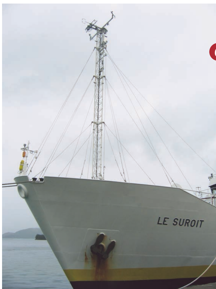
▲ Le navire océanographique Le Suroit équipé de son mât au port de Victoria (Seychelles). Sur la proue, une nacelle Aéroclipper installée pour une inter-comparaison avec le mât instrumenté.
