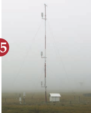
◀ Mât instrumenté mis en place sur le site de Toulouse Météopole dans le cadre de la campagne Toulouse-Fog. Ce dispositif permettait des mesures de température et d'humidité à 0,5, 1, 2, 5 et 10 mètres de hauteur, ainsi que des mesures du vent à 10 m.
