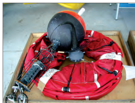
Bouée dérivante SVP-BS (baromètre + salinité)
