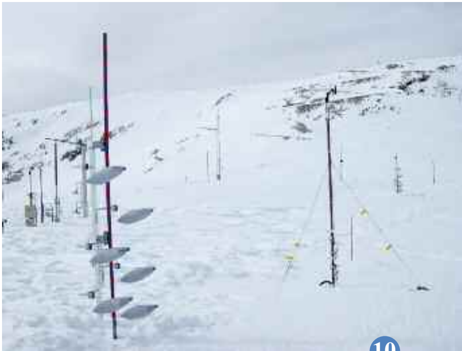
Dispositif expérimental de mesure du transport de neige par le vent sur le site du Col du Lac Blanc (2800 m d'altitude, Alpes françaises).
