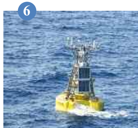
▲ La bouée Golfe du Lion lors de son remplacement, avec notamment les capteurs de flux radiatifs et de précipitations.
