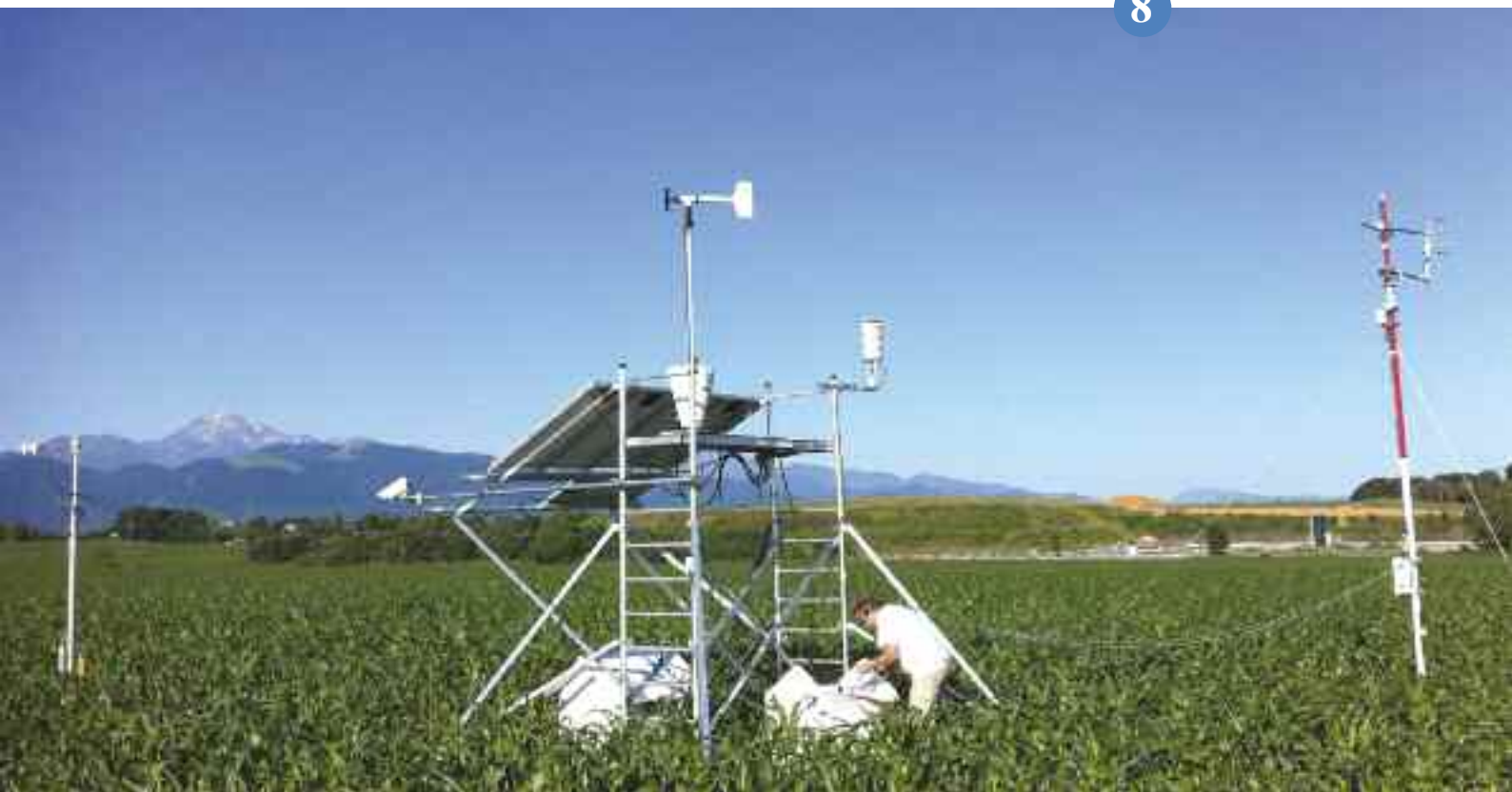
Station de mesure du bilan d'énergie sur une surface de maïs.
