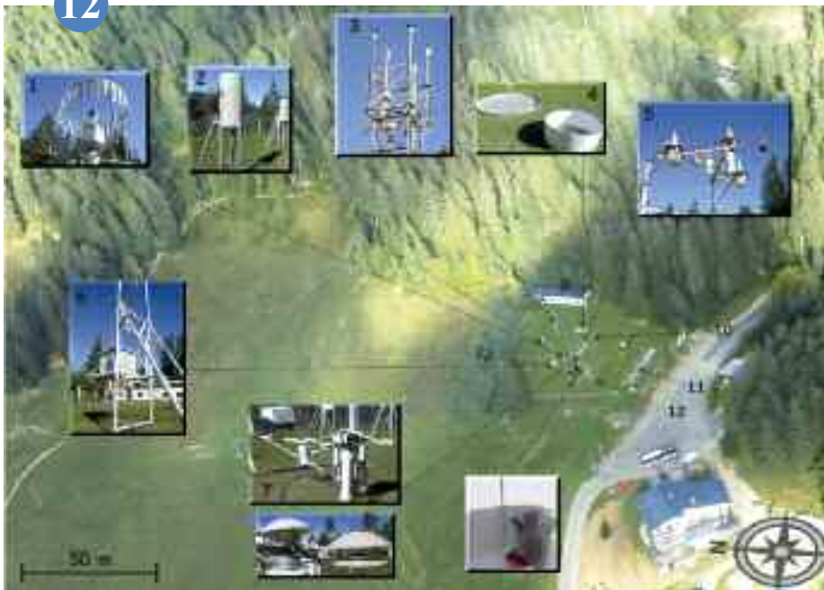
Vue d'ensemble du site nivo-météorologique du col de Porte et détail de quelques uns des instruments situés dans le parc de mesures.
